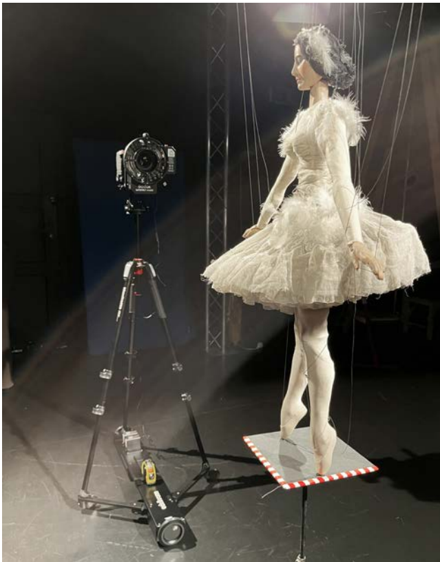
Salzburger Marionettentheater, Kamera und Stativ mit Dolly-System für automatisierte 360°-3D-Aufnahme der Marionette Ballerina Anna Pawlowa
